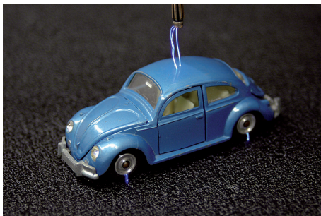
3. ábra. A Faraday-kalitkában belül a térerősség nulla.
